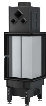
Dragon 8B XXL ECK — 4-13,7 kW Sichtfenster B/H/T: 450/680/450 mm
