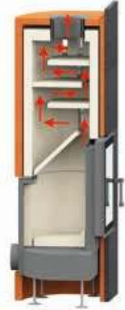
Schematische Darstellung des Zugsystems im City-Grundi
