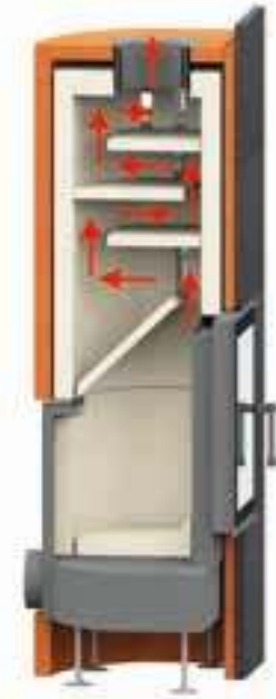
Schematische Darstellung des Zugsystems im City-Grundi
