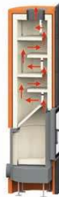
Schematische Darstellung des Zugsystems im City-Grundi
